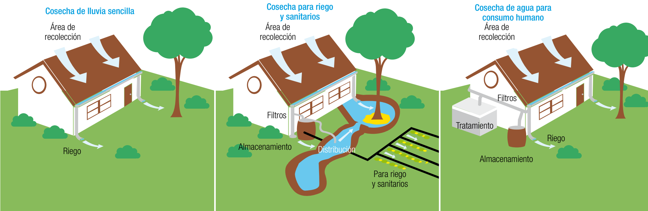
Figura 15. Técnicas para cosechar aguas lluvias
